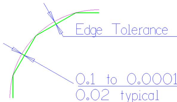
Figure 17 - Edge tolerance explanation
